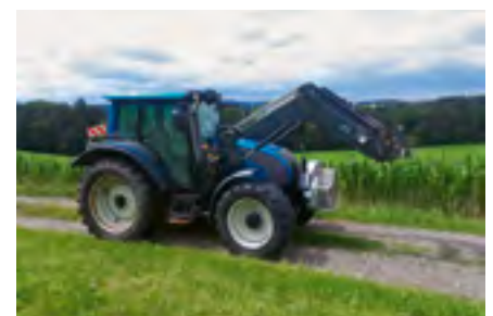
Fehlt die Fronthydraulik, ist auch ein fester Aufbau möglich, wie hier sogar in Kombination mit montiertem Frontlader.
