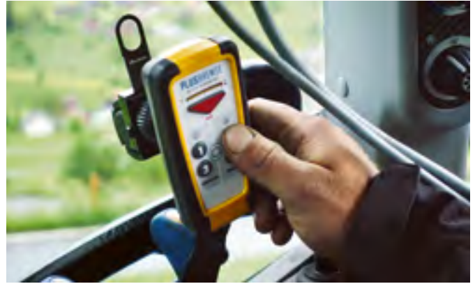
Die Bedienung des Geräts erfolgt serienmässig stufenweise über die Folientastatur der Funkfernbedienung.
