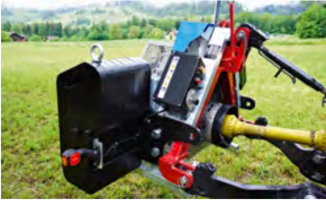
Die elektronische Ansteuerung ermöglicht am Drehregler eine anwenderfreundliche Verstellung der maximalen Bremsleistung.
