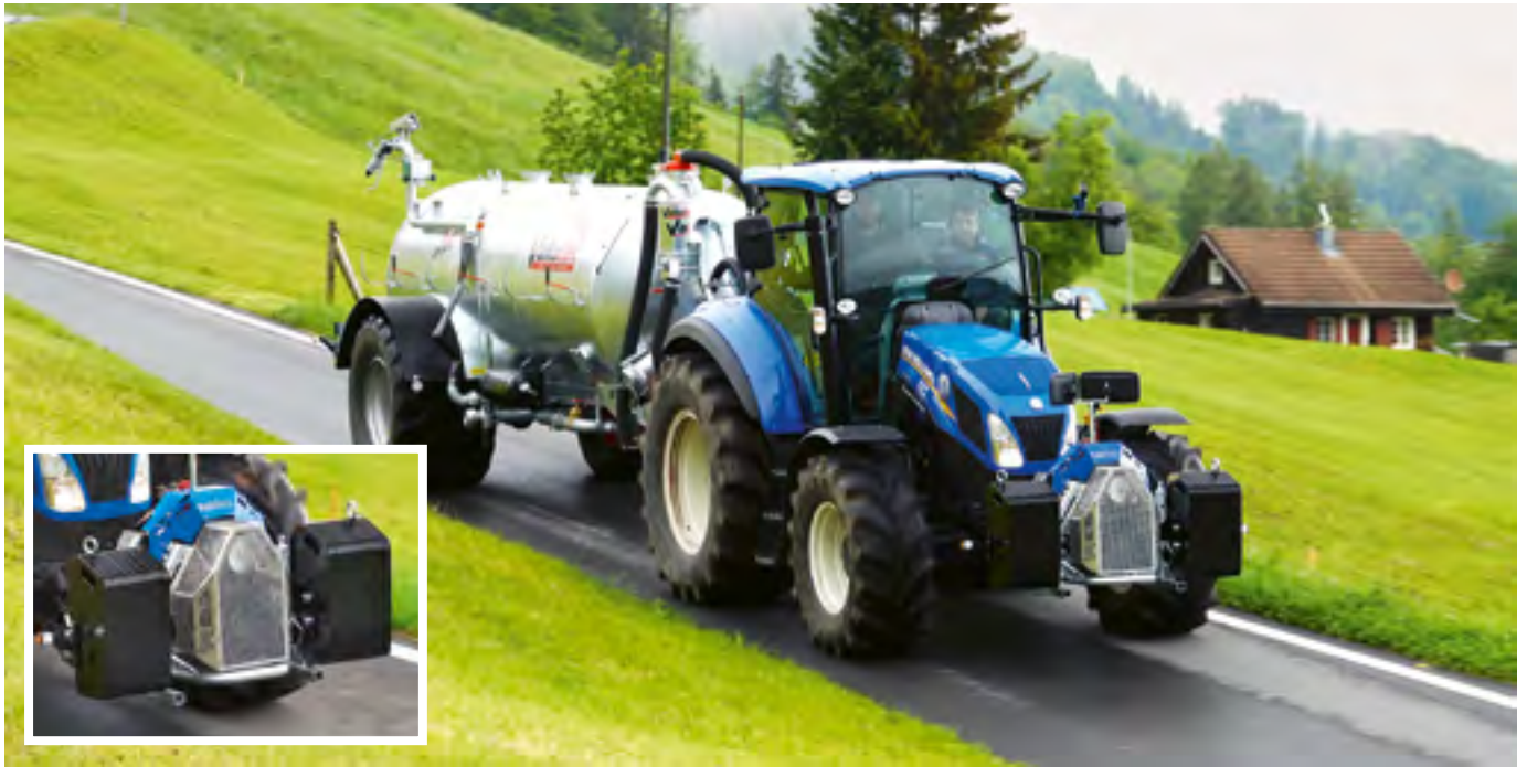
Die Betriebsbremsen bleiben dank «PlusBremse» auch auf längeren Talfahrten kühl und somit sicher einsatzbereit. Bilder: R. Burkhalter
