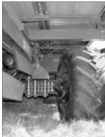
Die Achse hat eine Tragkraft von 6,6 Tonnen bei 40 km/h.
