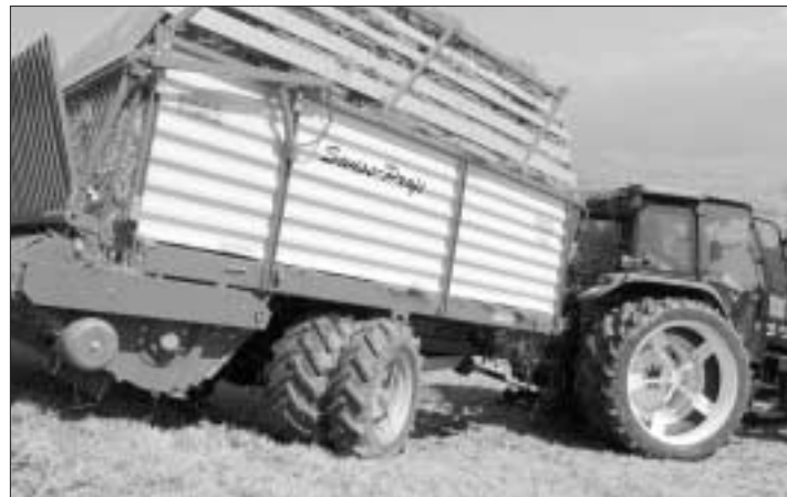
Die Lenktriebachse kommt für Betriebe mit Steillagen in Frage, die nicht auf den Traktor verzichten können.
